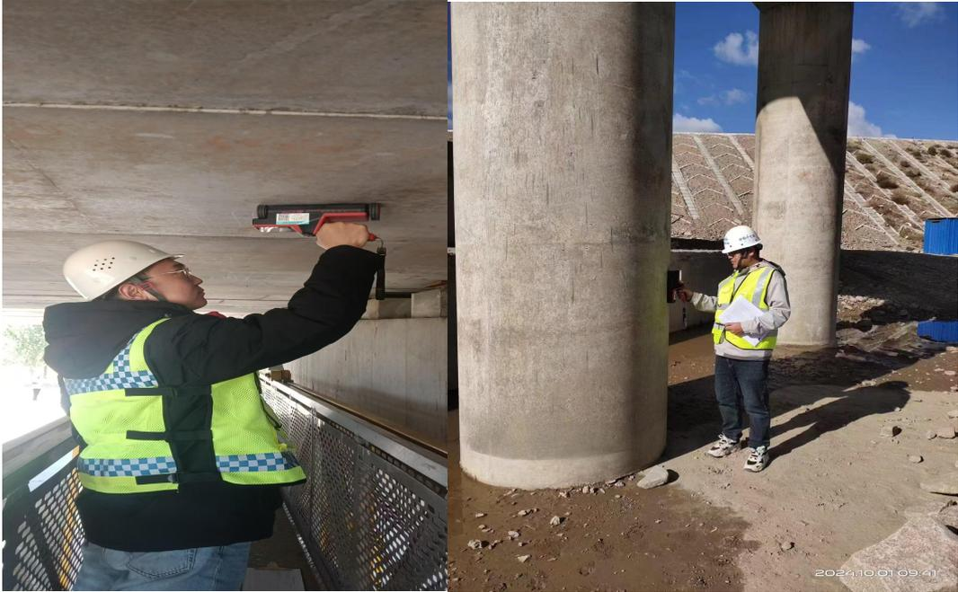
G65 包茂高速包头至东胜段改造工程交工验收前钢筋保护层检测现场
