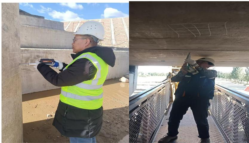
G65 包茂高速包头至东胜段改造工程交工验收前回弹强度检测现场
